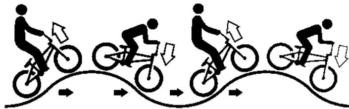
pumpen = antrieb ohne pedalieren
